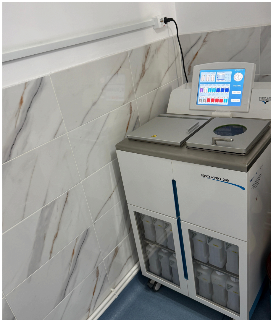
Procesator țesături histoprocesor automat cu vacuum
